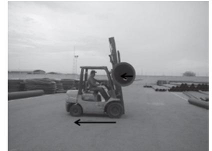
**4** Acerque el tubo al área de colocación y descienda ligeramente. Inclinando las paletas hacia adelante deje rodar el tubo a la zona de almacenamiento.
