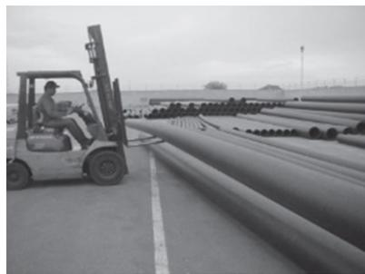
**3** Con el montacargas en retroceso frene de repente para que el tubo se deslice a la parte segura de carga y transporte el tubo.
