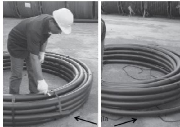
Colocándose dentro del rollo comience a retirar los sunchos con una cuchilla, comenzando desde la punta. Se observa que el rollo empieza a liberar energía, retire los zunchos poco a poco.
