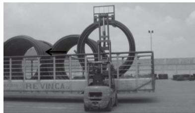
**2** Para la fila restante de rollos, repita el mismo procedimiento con el uso de los extensores del montacargas.
