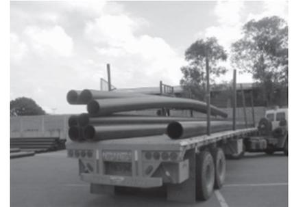
**2** Eleve las mismas con el uso del montacargas hasta una distancia de tuberías consecutivas. Coloque cuñas debajo de las barras, para facilitar la descarga de las mismas.
